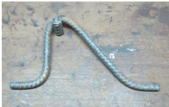
Figura 1. Conector de cisalhamento treliçado
