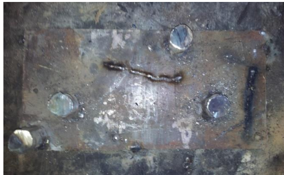
Figura 2. Detalhes da construção do conector de cisalhamento (medidas em cm)
