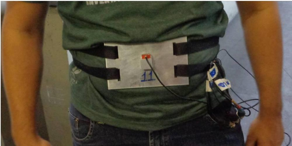
**Figura 22.** Placa com acelerômetro acoplados no centro de massa do pedestre
