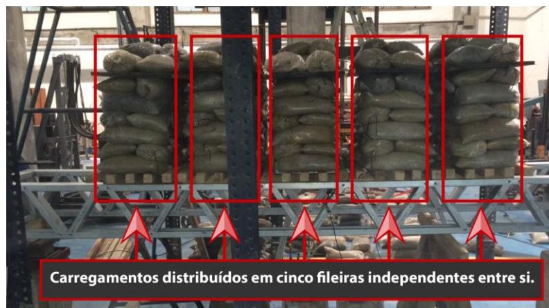
Figura 8. Esquema de distribuição dos carregamentos em paletes de madeira independentes entre si
