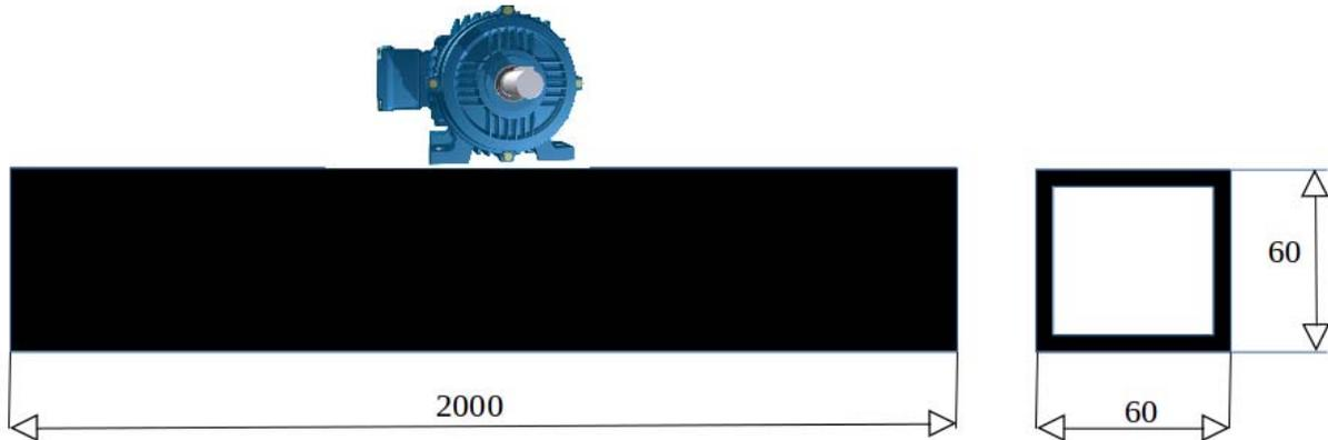
Figura 1 - Dimensões da viga. Espessura de 4,8. Todas as dimensões estão em mm.
