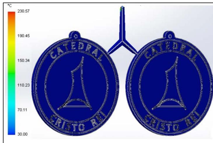
Figura 13 – Simulação de Injeção – Temperatura no Final da Injeção
