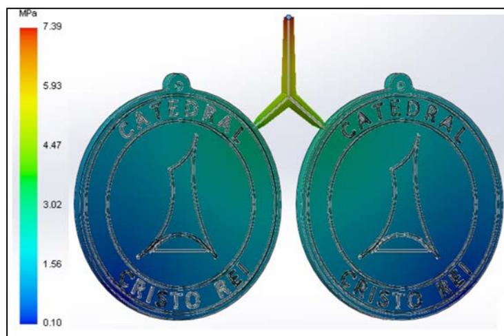
**Figura 12 – Simulação de Injeção – Tensão de Cisalhamento no Final da Injeção**
