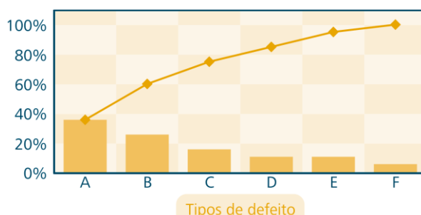
Figura 5 -Exemplo de diagrama de Pareto – distribuição de peças, segundo o tipo de defeito.
