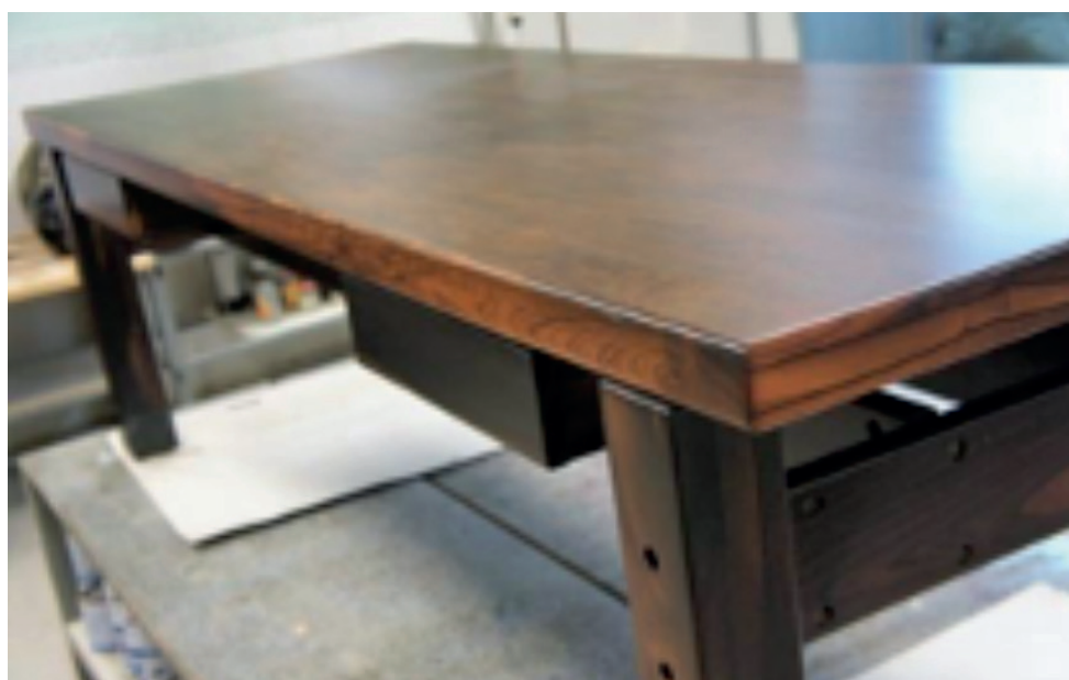
Figura 4: Restauro do tampo e da base e reconstrução das gavetas finalizada. Fonte: IFB
