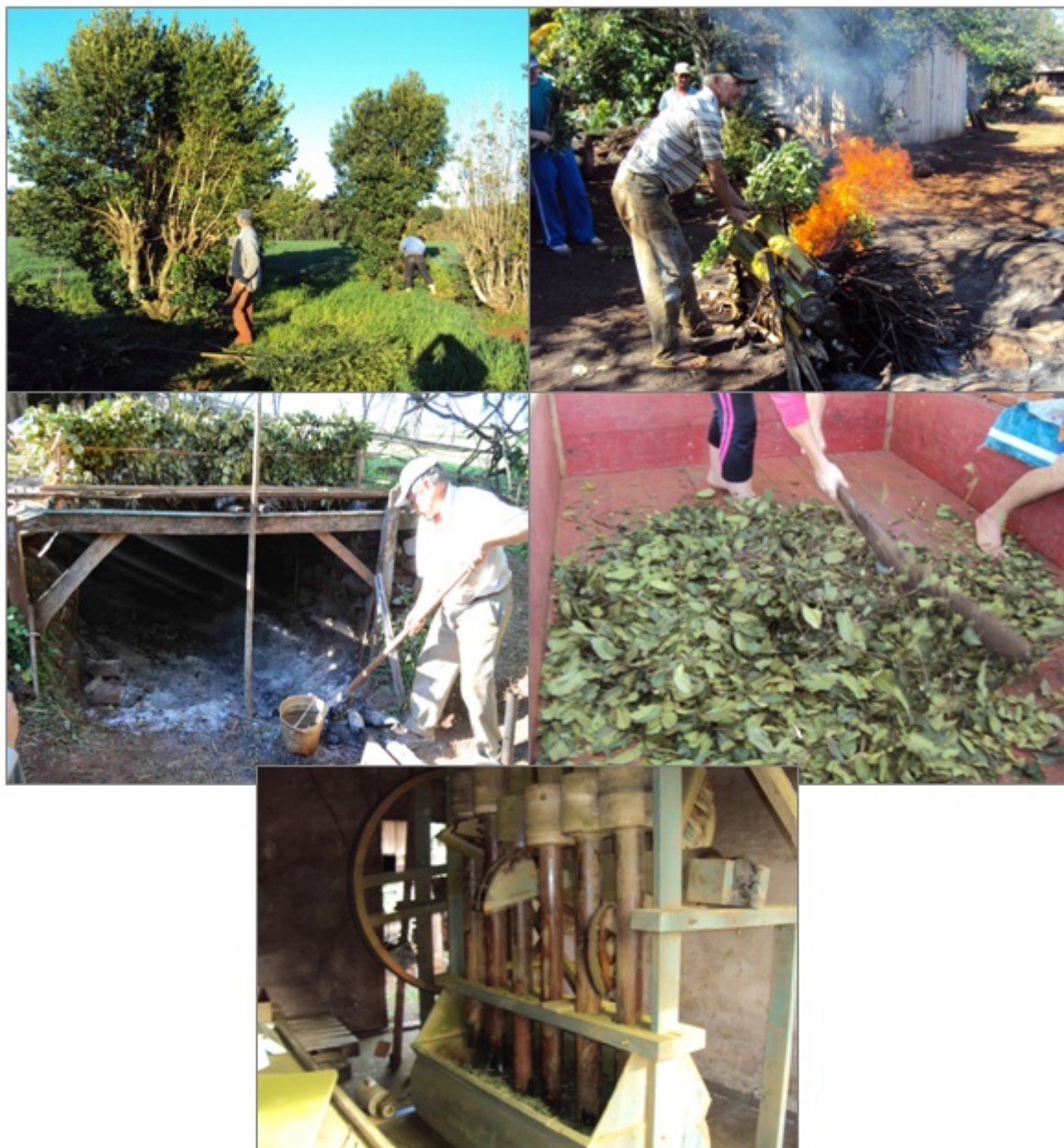
Figura 1. Da esquerda para a direita e de cima para baixo, a sequência do processamento artesanal de erva-mate: a) poda; b) sapeco; c) carijo com a erva seca após 12 horas de secagem; d) cancheamento com facão de madeira; e) soque. Rio Grande do Sul, 2010.
