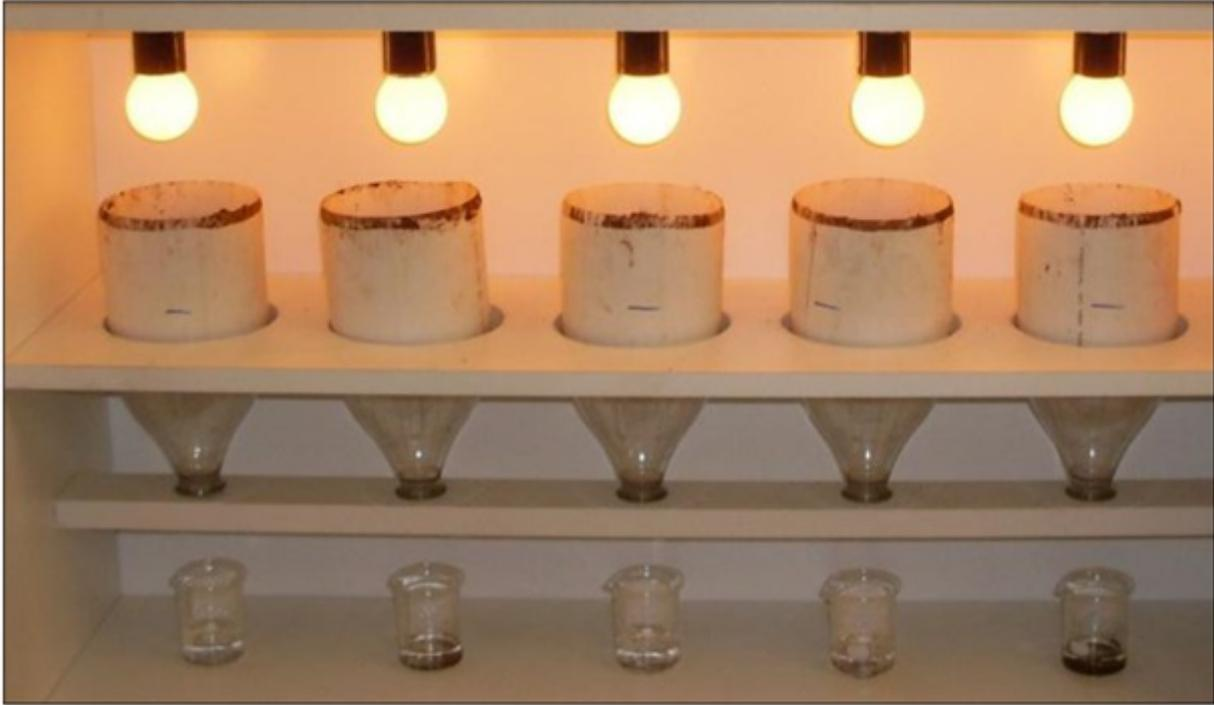
Figura 1. Detalhe do aparelho extrator de ácaros e colêmbolos das amostras de solo pelo método do funil de Berlese-Tullgren (Adaptado de RODRIGUES et al., 2008).
