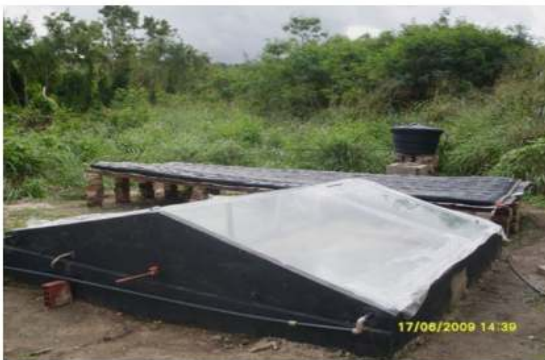
Figura 1: Caixa de alvenaria para evaporação/condensação da água após o aquecimento no coletor solar
