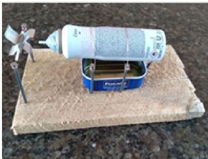
Figura 13: Usina Térmica (material utilizado e em funcionamento). Fonte: Acervo pessoal dos autores, 2019.
