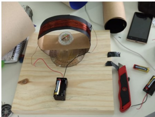
Figura 2: Experimento da bússola das tangentes construído na oficina. fonte: Autores (2019)
