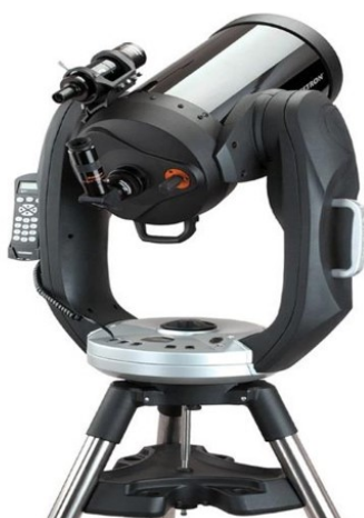
Figura 2: Telescópio Celestron CPC 8 do tipo Schmidt-Cassegrain Fonte: FERMARKET (2019).
