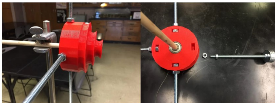
Figura 14: Sistema de polias empilhadas de diâmetros decrescentes.
