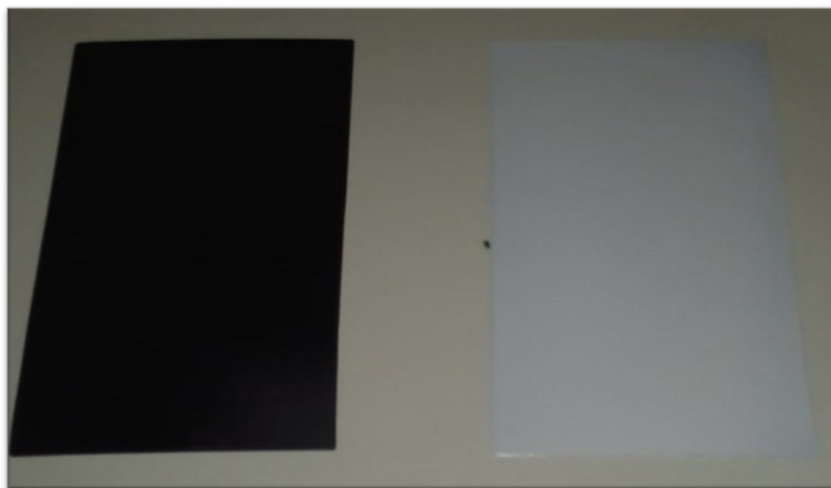
Figura 8: Duas placas de zinco, uma pintada de preto e a outra de branco.
