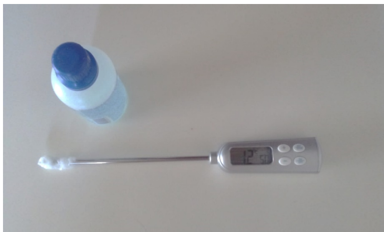
Figura 16: Algodão embebido com acetona. Temperatura final de 12°C.
