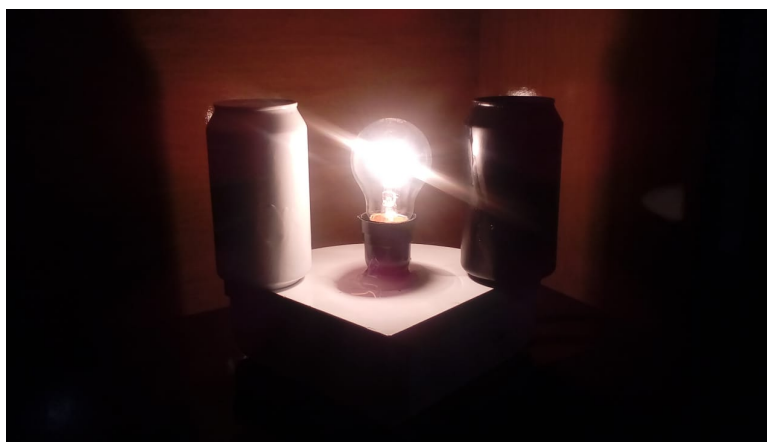
Figura 12: Lâmpada ligada irradiando energia para as latas.
