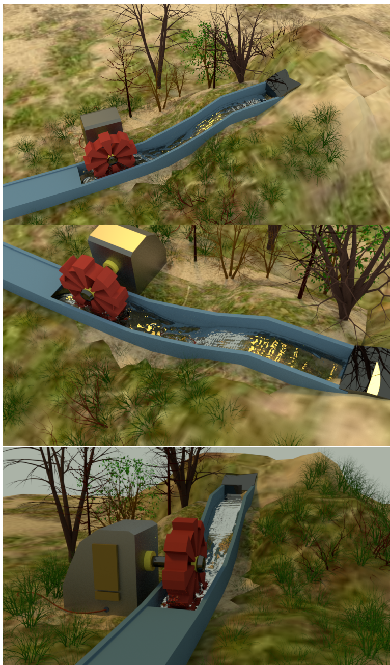
Figura 1: Simulação de uma pequena hidrelétrica. Nestes aparatos, a energia gravitacional armazenada no fluido é convertida em energia elétrica. Esta transferência é dada pela troca de energia cinética entre o fluido e a roda d'água. A ideia por trás desta configuração é usada até hoje.
