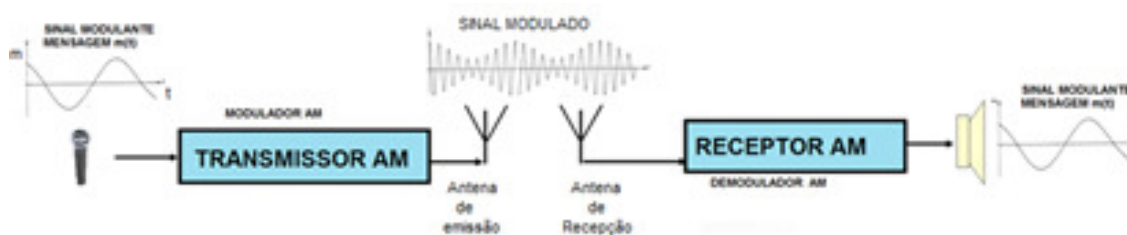
Figura 7: Esquema simplificado de uma transmissão em AM de um sinal harmônico.
