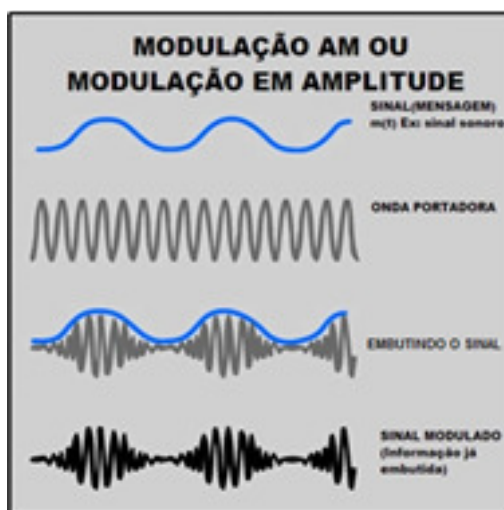
Figura 6: Modulação em amplitude de um sinal harmônico simples.
