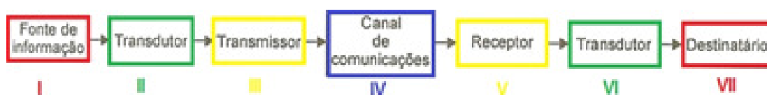
Figura 1: Diagrama em blocos de uma comunicação analógica simples.
