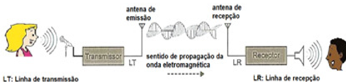
Figura 3: Esquema básico de comunicação via rádio.
