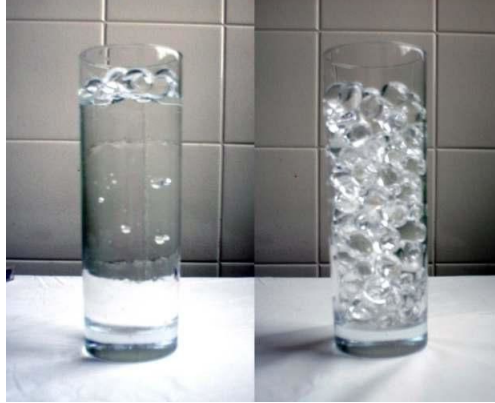
Figura 1: Esferas de hidrogel (à esquerda) desaparecem quando mergulhadas em água (à direita), devido à igualdade de índices de refração das esferas e do líquido.
