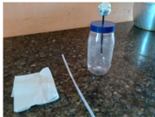
Figura 15: Eletroscópio (em funcionamento). Fonte: Acervo pessoal dos autores, 2019.
