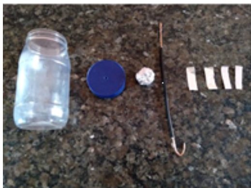
Figura 14: Eletroscópio (material utilizado). Fonte: Acervo pessoal dos autores, 2019.
