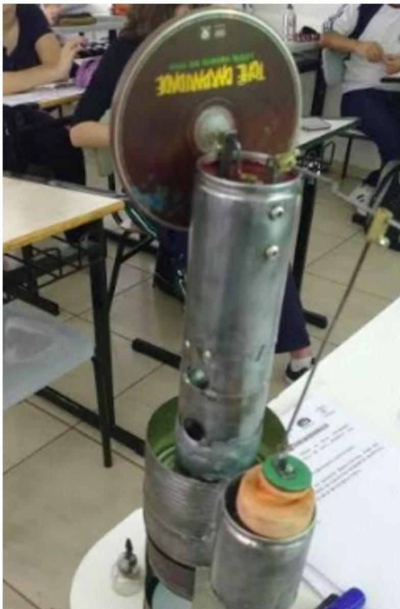
**Figura 2:** *Motor de Stirling*
