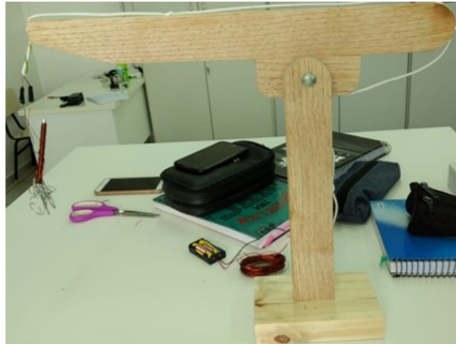
Figura 3: Experimento do guindaste eletromagnético construído na oficina. fonte: Autores (2019)
