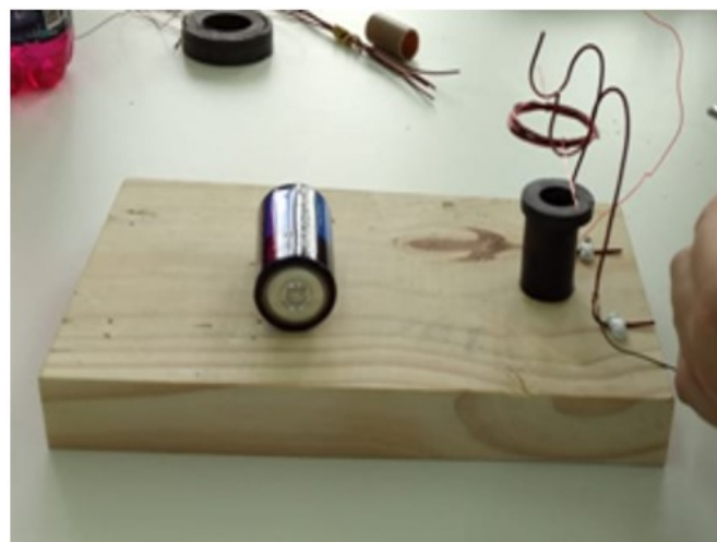
Figura 4: Experimento do motor elétrico construído na oficina. fonte: Autores (2019)
