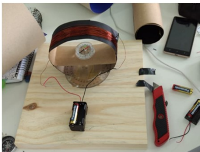
Figura 2: Experimento da bússola das tangentes construído na oficina. fonte: Autores (2019)
