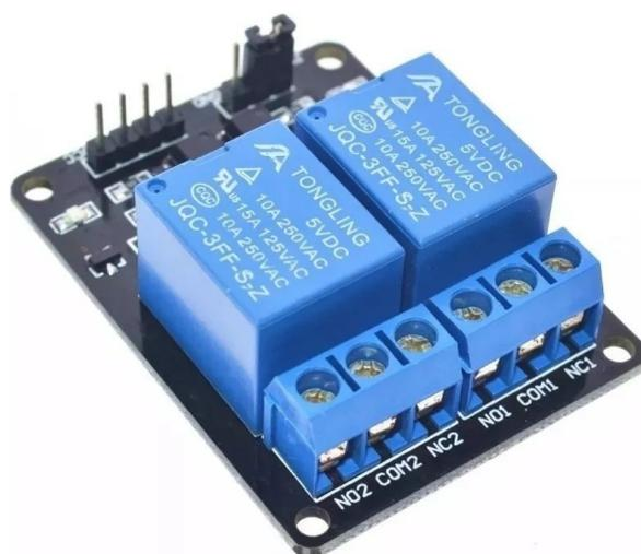
**Figura 6:** Relés utilizados para o controle da cúpula [13].
