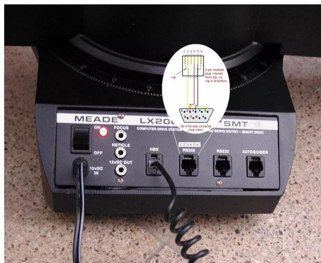
Figura 11: Entrada de sinal do telescópio.
