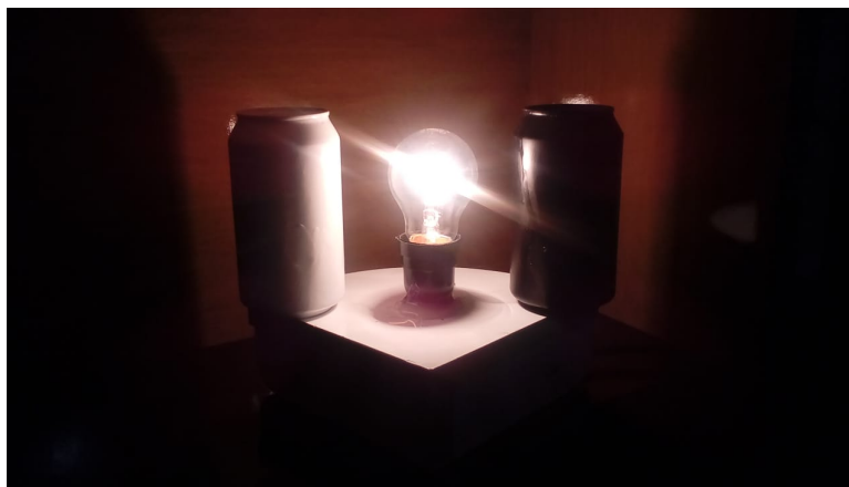
Figura 12: Lâmpada ligada irradiando energia para as latas.
