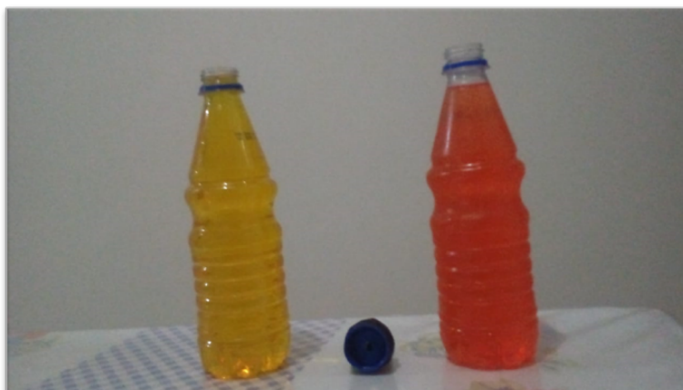
Figura 6: Recipientes com corantes adicionados à água. Água quente amarela à esquerda e água fria vermelho-alaranjada à direita.
