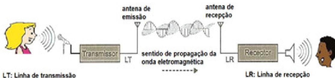
Figura 3: Esquema básico de comunicação via rádio.
