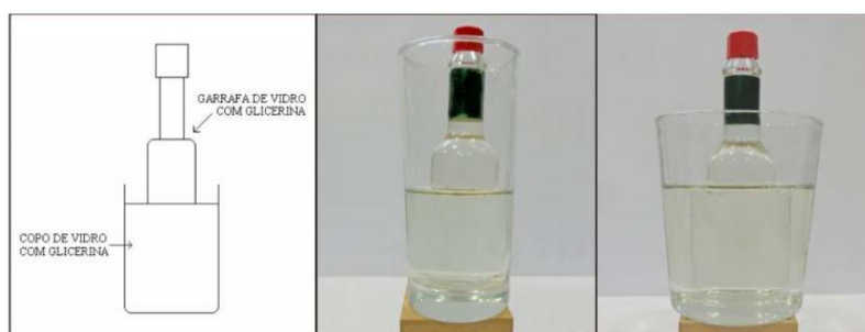
Figura 5: A garrafa de vidro desaparece quando é imersa em um copo cilíndrico de menor diâmetro (centro), mas seu contorno se torna em copo de maior diâmetro (direita).
