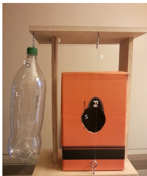
Figura 2: Aparato experimental montado. 1: Reservatório. 2: Orifício lateral para auxiliar o enchimento do reservatório. 3: Estrutura de madeira. 4: Corda de violão. 5: Caixa de ressonância
