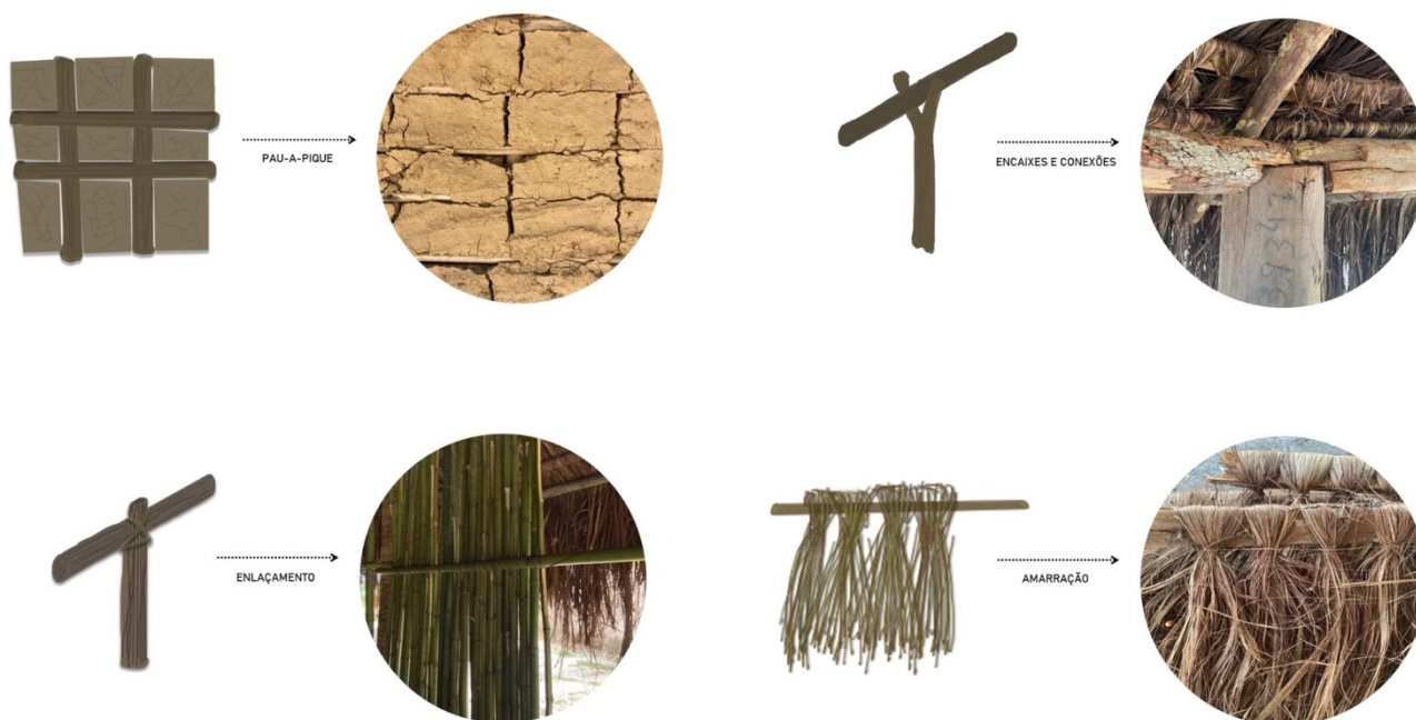
Figura 15 – Detalhes construtivos - amarração e encaixes
