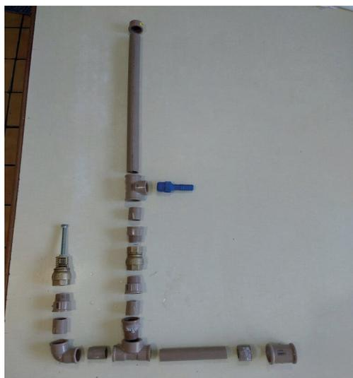
Figura 4 - Peças do carneiro hidráulico montado pelos integrantes do projeto. Acervo Núcleo Extensionista Rondon IFPR, Campus Palmas.
