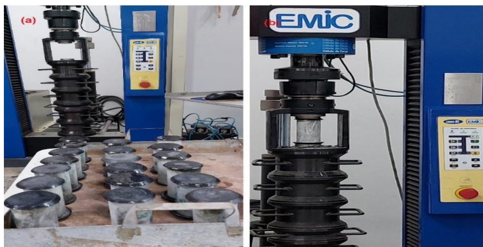
Figura 5: Corpos de prova cilíndricos capeados (5a) e submetidos ao ensaio de resistência à compressão axial (5b).
