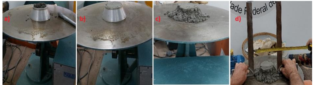
Figura 2: Determinação do índice de consistência das argamassas.
