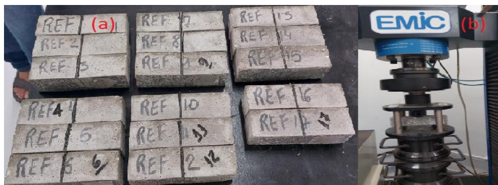
Figura 4: Procedimento do ensaio de resistência à tração na flexão e compressão.
