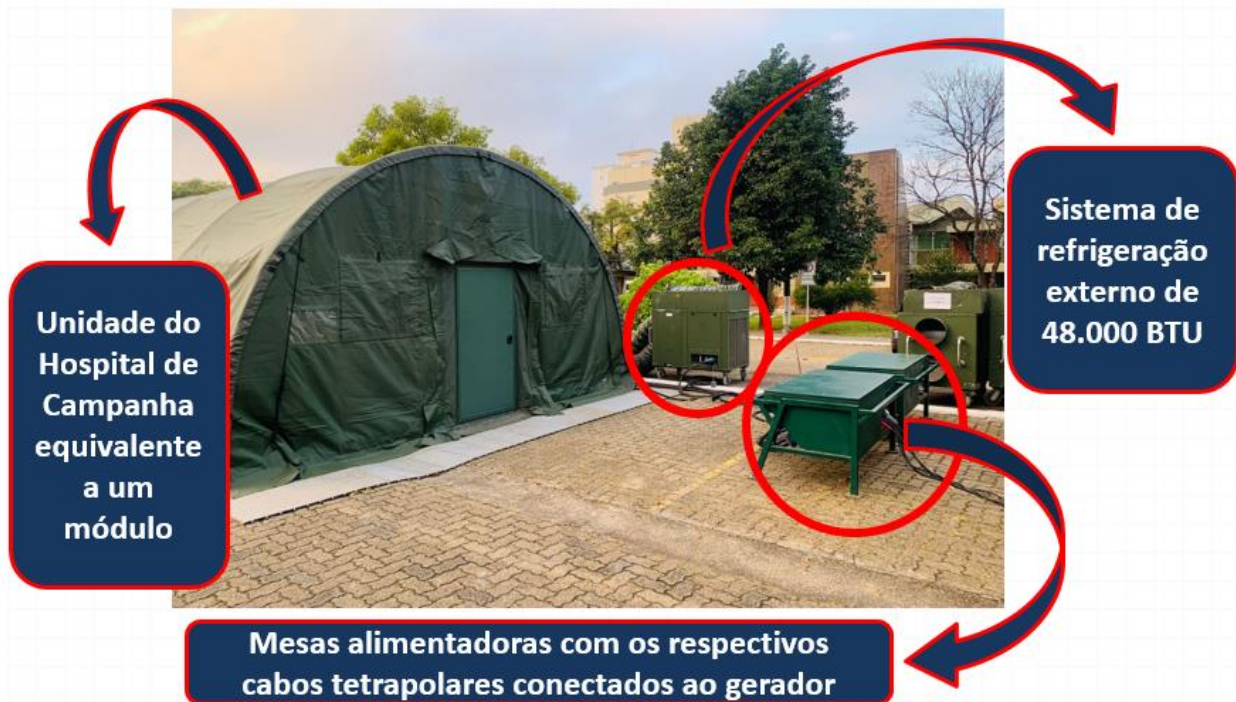
Figura 3: Estrutura de um hospital de campanha.
