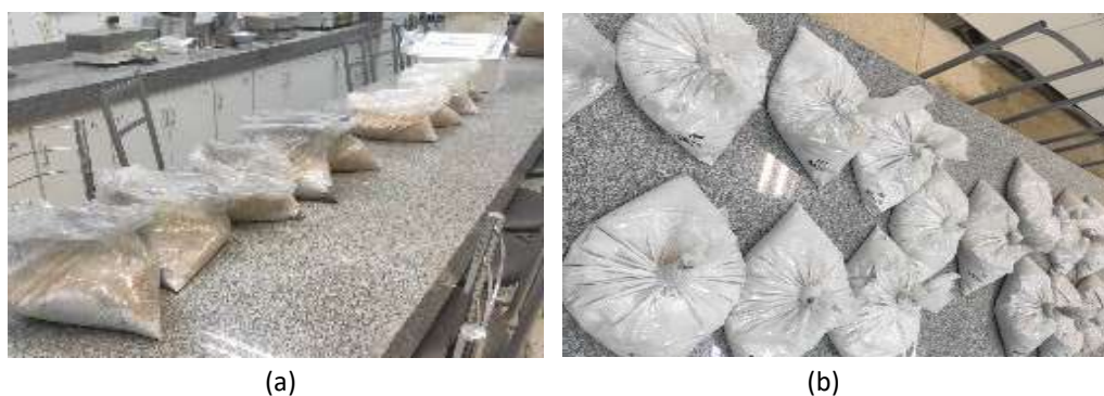
Figura 2: Traço ideal da argamassa modificada com cinzas de biomassa: pré-dosagem (a) e acondicionamento em sacos plásticos (b).
