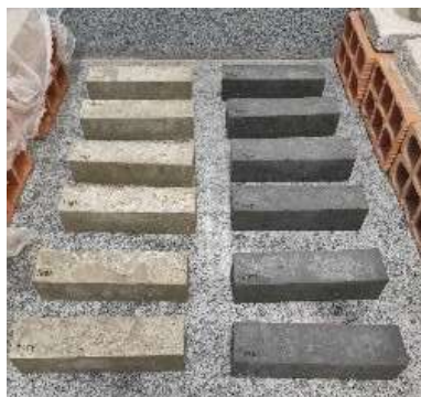
Figura 3: Corpos de prova prismáticos 4x4x16 cm T ref e T méd , dosados em t 0 .
