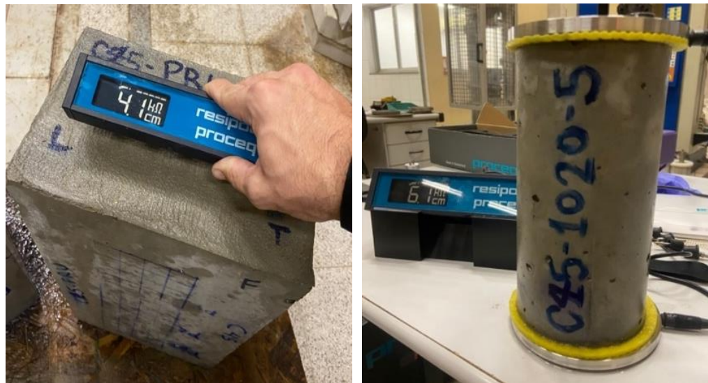
Figura 2: Ensaios de resistividade elétrica superficial no prisma (à esquerda) e volumétrica nos corpos de prova cilíndricos (à direita).
