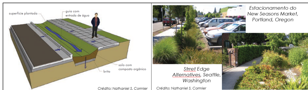
Figura 7: Exemplos esquemáticos de biovaletas e suas aplicações.
