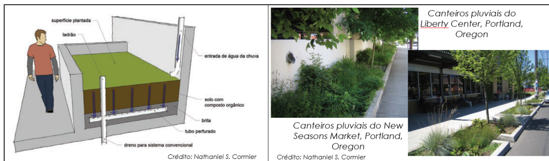
Figura 6: Exemplos esquemáticos de canteiro pluvial (célula de birretenção) e suas aplicações.
