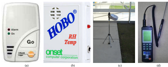
Figura 5: Equipamentos utilizados para as medições (a) registrador Testo, (b) HOBO RH/Temp; (c) equipamentos protegidos da radiação solar direta e da chuva (d) sensor de esfera quente Testo, conectado no registrador multifunção Testo.
