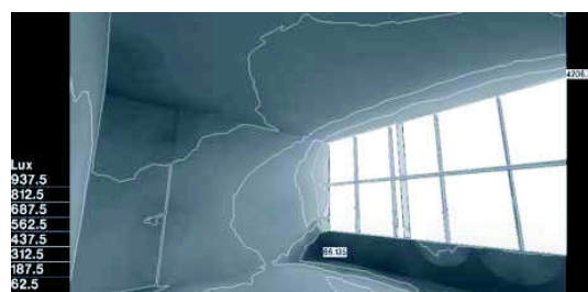
Figura 14: Simulação de iluminação natural dos gabinetes (às 10 horas) situação proposta (Fonte: AMORIM et al, 2006)
