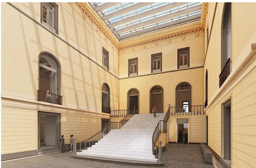
Figura 13. Anteprojeto de Restauração e Arquitetura do Paço de São Cristóvão: instalação de cobertura na escadaria monumental.
