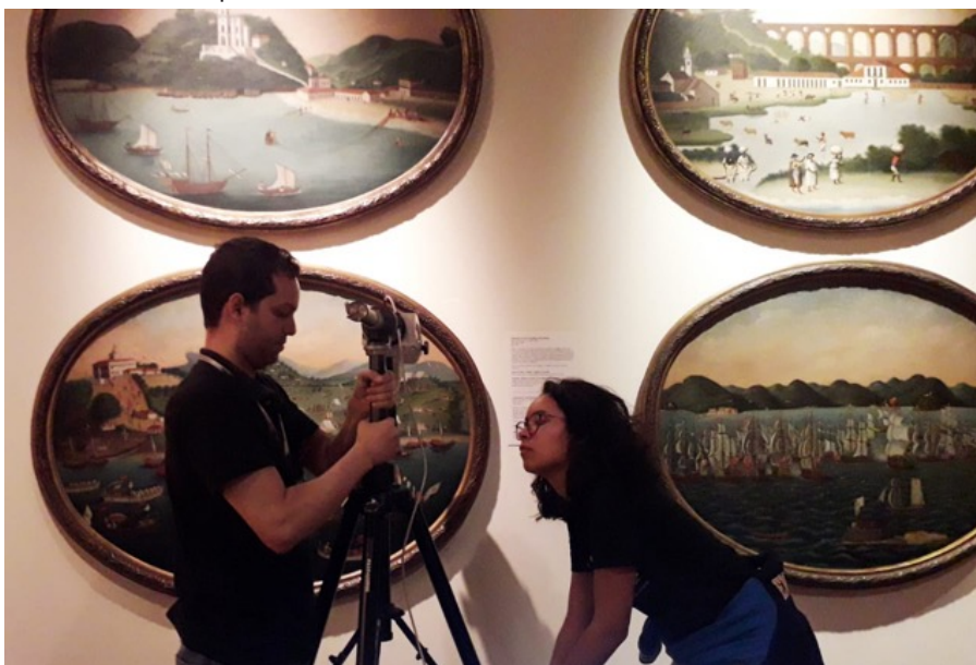
Figura 1: Exemplo de análise por técnica físico-química, em obras de arte 3 , realizada com um instrumento portátil de Fluorescência de Raios X.
