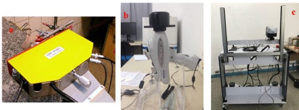
Figura 2. Diferentes sistemas portáteis de XRF; desenvolvidos em laboratório (a); recente sistema comercial (b); sistema portátil de MA-XRF (c).
