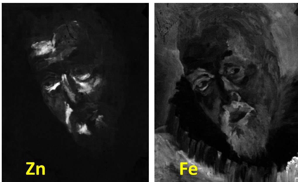
Figura 9. Imagens de MA-XRF da distribuição dos elementos zinco (Zn) e ferro (Fe) registrados na tela.
