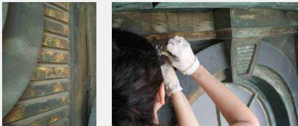
Figura 4 Lanternim; a) Área onde foram feitas as análises do cobre e dos resíduos de douramento; b) Camada de douramento do friso do Lanternim; c) Coleta dos resíduos de douramento na região da Caixilharia do basculante do Lanternim. Fonte: Campos (2008)
