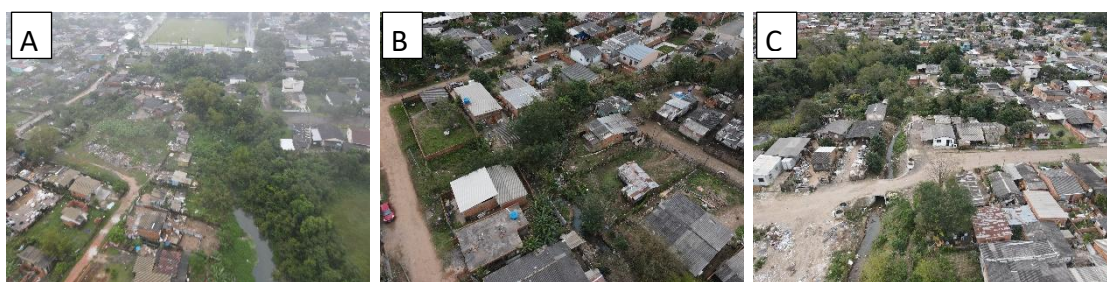
Figura 9. Fotografias oblíquas baixas das residências com processos de erosão de margem na Vila Babilônia(A), nas margens do arroio da Lúdia (B) e do canal artificial (C)
