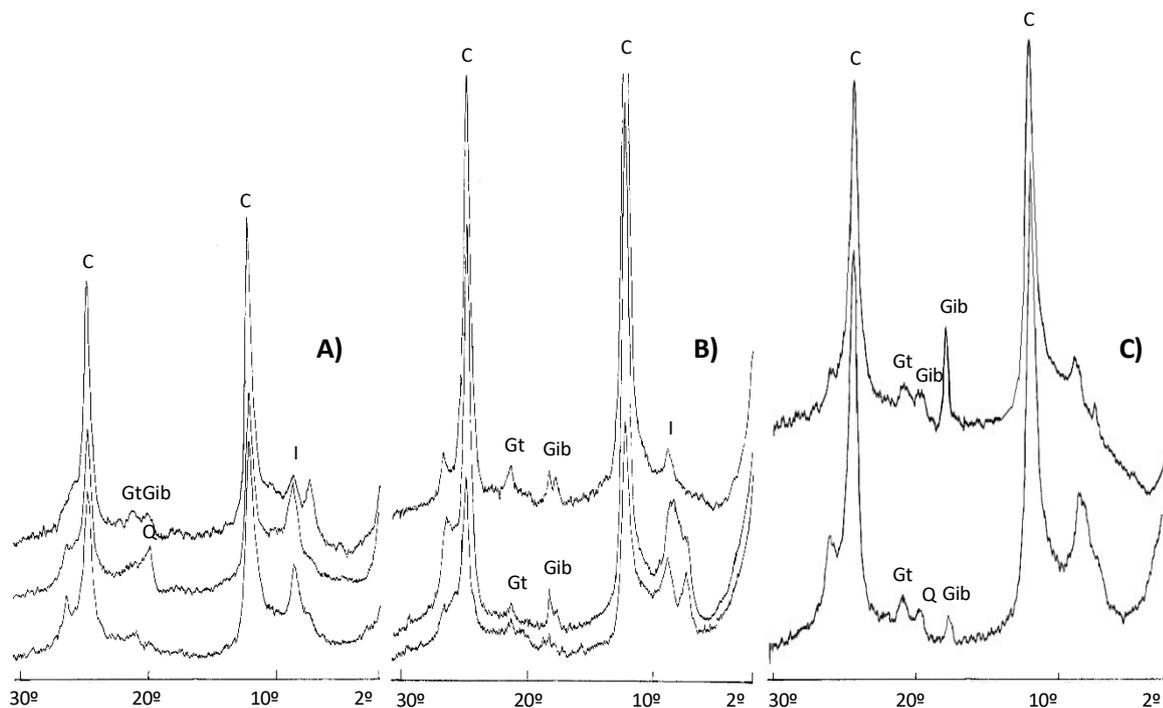
Figura 8. Difrátogramas sem tratamento da fração argila. A) Perfil 1; B) Perfil 6; C) Perfil 9; C: caulinita, Gb: gibsitita, Gt: goetita, I: ilita.
