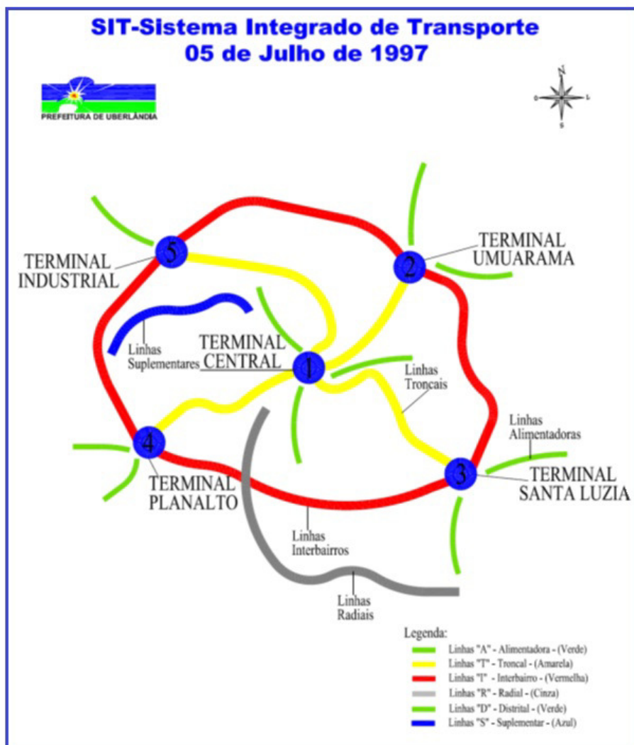
Figura 2: Esquema de funcionamento do SIT.
