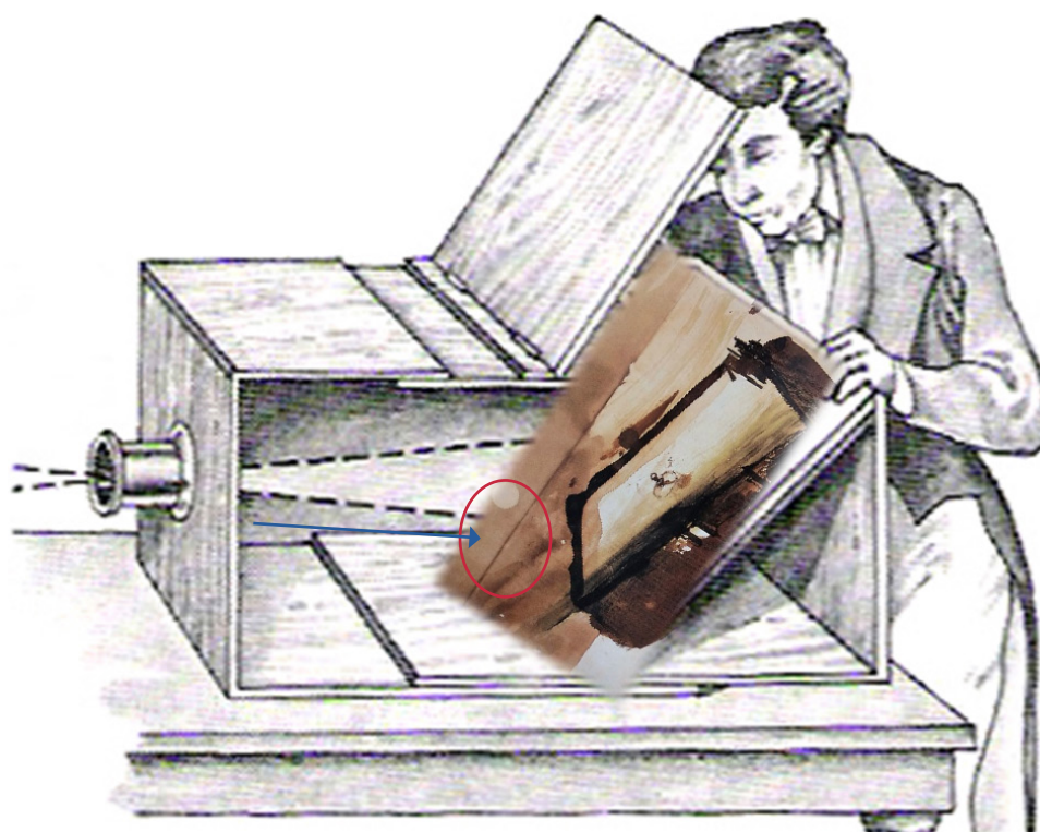
Fig. 16: Mecanismo completo de uma câmara obscura. Colagem a partir de Jones (2015)
