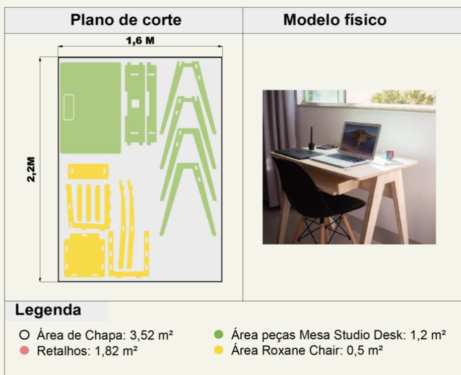
Figura 1. Plano de corte design flat pack da Opendesk e execução do autor.
