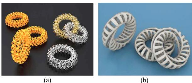
Por meio da interpretação das coordenadas do objeto virtual o equipamento de prototipagem as transforma em um objeto real, geralmente em resina ou metal, através de máquinas que executam uma "impressão" tridimensional. O processo ocorre pela deposição de camadas de material, inversamente ao processo que ocorre na tomografia, ou por meio de vários eixos de fresas, que esculpem o modelo a partir de um bloco de
