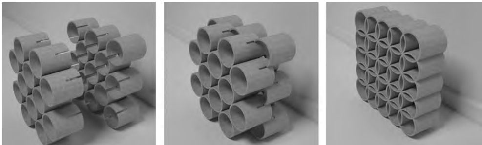
Figura 1. Experimentações sobre as possibilidades de encaixe com tubos de papelão.
