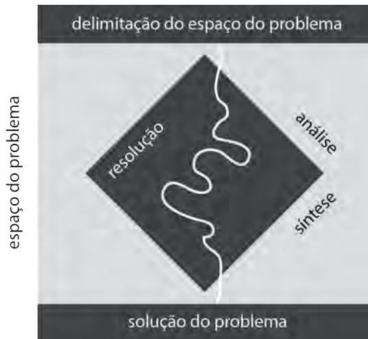
Figura 4. Esquema que evidencia o caráter de desconstrução divergente (análise) e reconstrução convergente (síntese) no processo de resolução de problemas.
