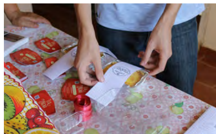
Figura 10. Adição manual da cinta com fechamento por fita dupla face.
