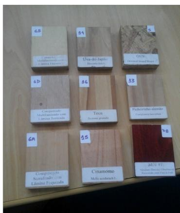
B - Seção transversal, em ordem: Teca, Compensado laminado, Compensado sarrafiado, Cinamomo, MDF, OSB e Bambu.
