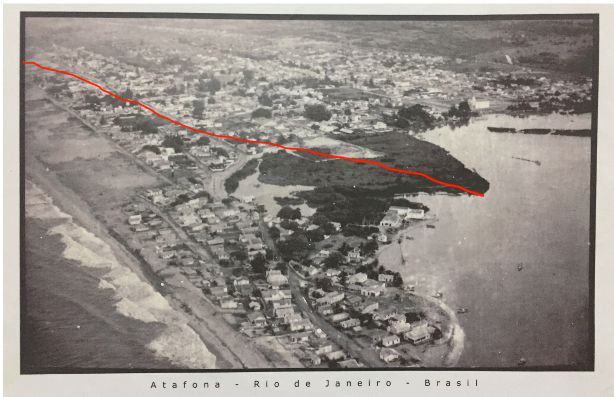
Foto aérea de Atafona no ano de 1969, autoria desconhecida, a linha vermelha indica aproximadamente a posição atual da linha de costa.
