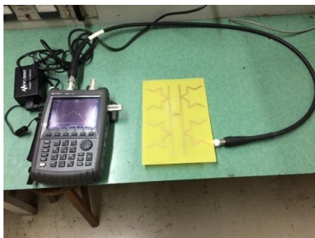
Figura 4 – Conexión para la medición del VSWR de una de las antenas de prueba.
